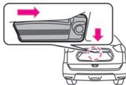
4 ソケットを矢印の方向に回して引き抜きます。
