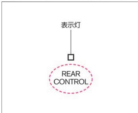
3. **REAR CONTROL** スイッチの表示灯が消灯しているときは、**REAR CONTROL** スイッチをタッチします。(スイッチの表示灯が点灯)
