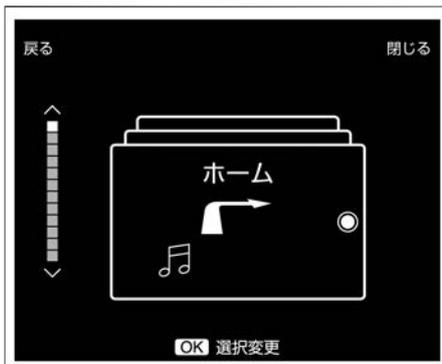
4. 表示させたい項目を、ステアリングスイッチのOKスイッチ②を回して選択し、OKスイッチ②を押して選択すると表示できるようになります。
