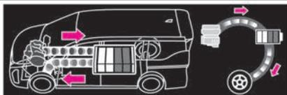
・エンジンで発電したエネルギーで、走行と充電の両方をしている状態
