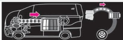
・エンジンで発電したエネルギーで、リチウムイオンバッテリーを充電している状態
