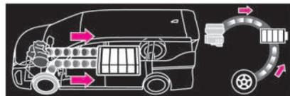
・エンジンと回生ブレーキ、両方のエネルギーで充電している状態
