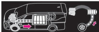
・回生ブレーキを使ってリチウムイオンバッテリーを充電している状態
