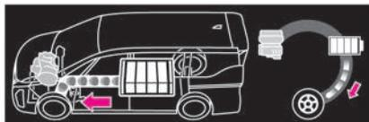
・リチウムイオンバッテリーに蓄えられたエネルギーを使って走行している状態
