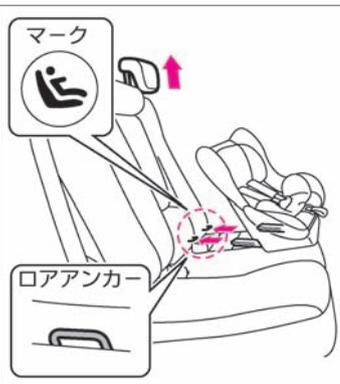
**2** テザーアンカーは、後席シート背もたれ裏側にあります。テザーアンカーにフックを固定し、テザーベルトを締めます。チャイルドシートを前後左右にゆすり、しっかり固定されていることを確認します。
