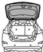
2 お手持ちの工具でリヤコンビランプのボルトを外し、ランプをまっすぐ後方に引いて取り外します。
