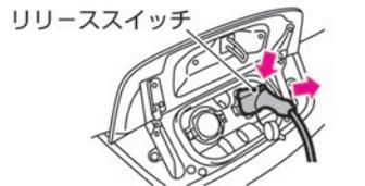
9 充電ポートのキャップ①を閉めてから、充電ポートリッド②を閉めます。プラグをコンセントから抜き、充電ケーブル（コントロールボックス付）を収納袋に収納します。
