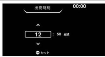
7 ステアリングスイッチの ▲▼ スイッチで 「分」を設定し、**OK** スイッチを押します。設定時間は10分単位で切り替わります。
