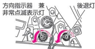
4 古い電球を引き抜き、新しい電球をソケットに取り付けます。取り外したときと逆の手順で取り付けます。
