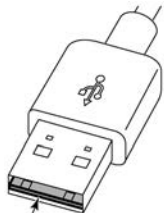
リバーシブルタイプUSBコネクター (接点基板が中央にある)
